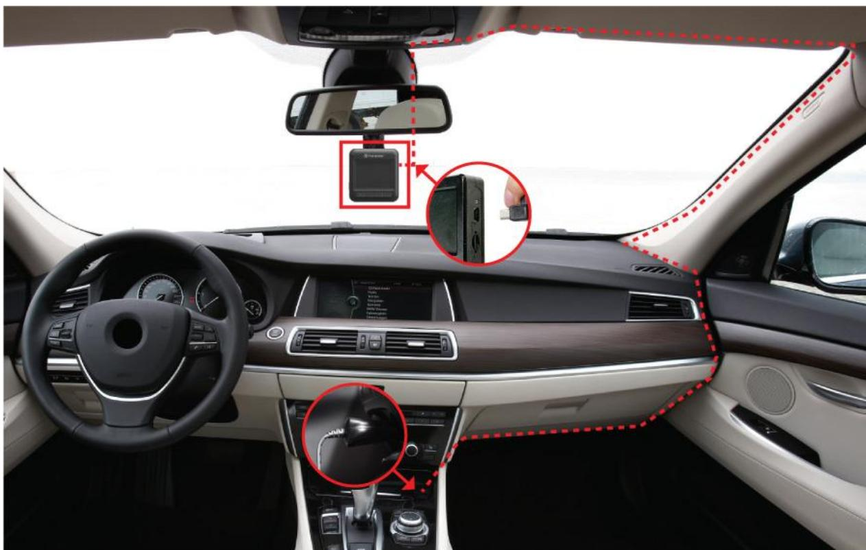
1. Verbinden Sie das kleine Ende des KFZ-Kabels mit dem USB-Anschluss der DrivePro.
